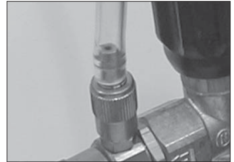
Figura 5 - Conecte el tubo de succión al conector dentado
