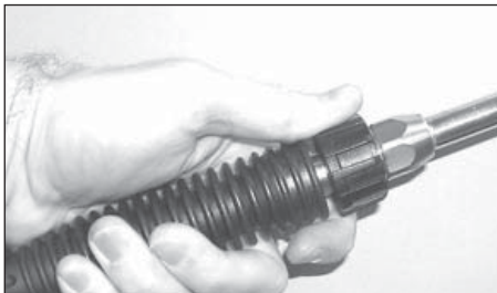
Figura 9 - Conecte la lanza a la pistola
