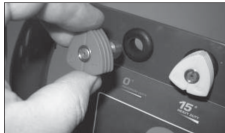
Figura 6 - Inserte las boquillas de pulverización en el soporte
