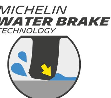
*Las laminillas patentadas con la tecnología MICHELIN Water Brake permiten ofrecer un agarre excepcional en mojado. La tecnología MICHELIN Water Brake incluye laminillas transversales para mejorar la frenada en mojado, los chaflanes en los bordes de las laminillas evitan una forma de desgaste irregular en condiciones de utilizaciones severas. Las laminillas transversales permiten que la llanta rompa la película de agua y así asegura una frenada excepcional en mojado.*
