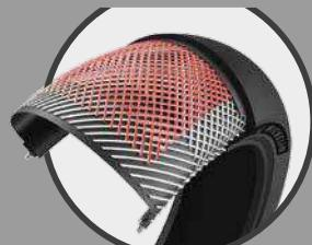
*Estructura bias de la carcasa de la llanta cinchada en la cima mediante un cinturón formado por una o dos capas de lonas cruzadas.*
