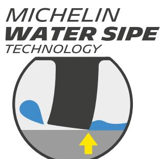
*La tecnología MICHELIN Water Sipe ofrece más agarre en mojado, gracias a las laminillas patentadas que aumentan la capacidad de evacuación del agua. Un aumento gradual de las laminillas permite que la llanta rompa la película de agua.*
