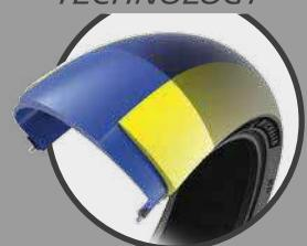
*Una goma más dura debajo del compuesto blando de los hombros proporciona una mayor rigidez en inclinación en las curvas para una mayor estabilidad, especialmente bajo fuerte aceleración o fuerte frenada.*
