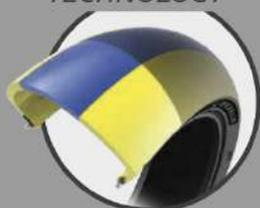
*Un compuesto de goma más duro en el centro de la banda de rodadura, para resistir al desgaste, y más blando en los hombros para un mayor agarre en curva.*
