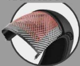
*Estructura bias de la carcasa de la llanta cinchada en la cima mediante un cinturón formado por una o dos capas de lonas cruzadas.*
