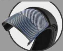
*La nueva generación de carcasa X-radial combinada con una lona de refuerzo es la solución óptima para motos pesadas al mejorar el confort de conducción sin comprometer la seguridad.*
