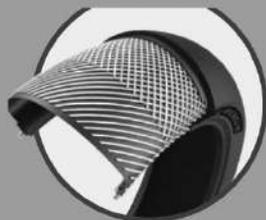
*La carcasa de una llanta diagonal está constituida por 2 o más capas de lonas con cables orientadas oblicuamente y cruzadas entre ellas. El ángulo que forma las 2 lonas cruzadas se adapta en cada tipo de llanta para cambiar las prestaciones. La estructura es homogénea, la cima y los flancos ofrecen propiedades mecánicas semejantes y hace que pueda soportar mucha carga.*
