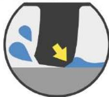
Las laminillas patentadas con la tecnología MICHELIN Water Brake permiten ofrecer un agarre excepcional en mojado. La tecnología MICHELIN Water Brake incluye laminillas transversales para mejorar la frenada en mojado, los chaflanes en los bordes de las laminillas evitan una forma de desgaste irregular en condiciones de utilizaciones severas. Las laminillas transversales permiten que la llanta rompa la película de agua y así asegura una frenada excepcional en mojado.
