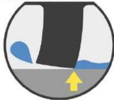
La tecnología MICHELIN Water Sipe ofrece más agarre en mojado, gracias a las laminillas patentadas que aumentan la capacidad de evacuación del agua. Un aumento gradual de las laminillas permite que la llanta rompa la película de agua.
