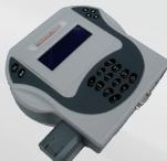
**UNIDAD DE ANÁLISIS DE LAS EMISIONES DE GAS PARA INTEGRAR CON UNIDADES DE PANTALLA EXTERNA** (ordenador, por cable o bluetooth, inalámbrico) específico para línea de revisión/módulo DIR/RED.
