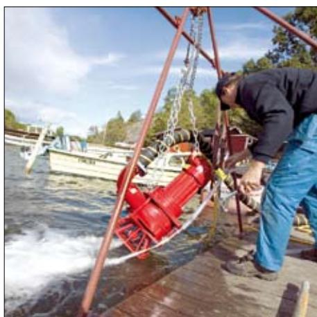
Para dragados, la bomba se puede equipar con chorros de agua externos que agiten los sólidos sedimentados.
