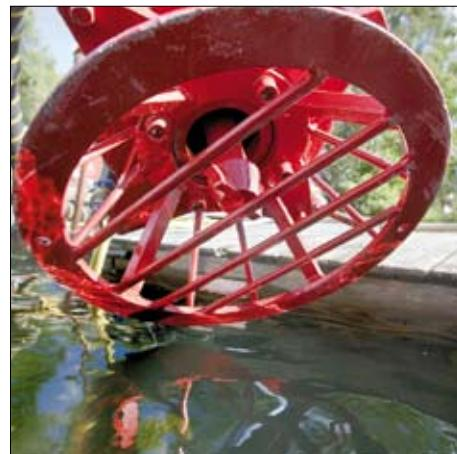
El agitador levanta los sólidos sedimentados.
